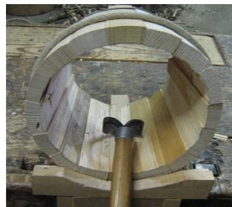
Le polissage se fait à la plane. Une main la tient par le manche, l'autre par-dessus le fer, s'accroche par le milieu des doigts. Cela permet d'effleurer le bois du récipient avec le bout des doigts et de sentir ainsi la qualité du polissage
